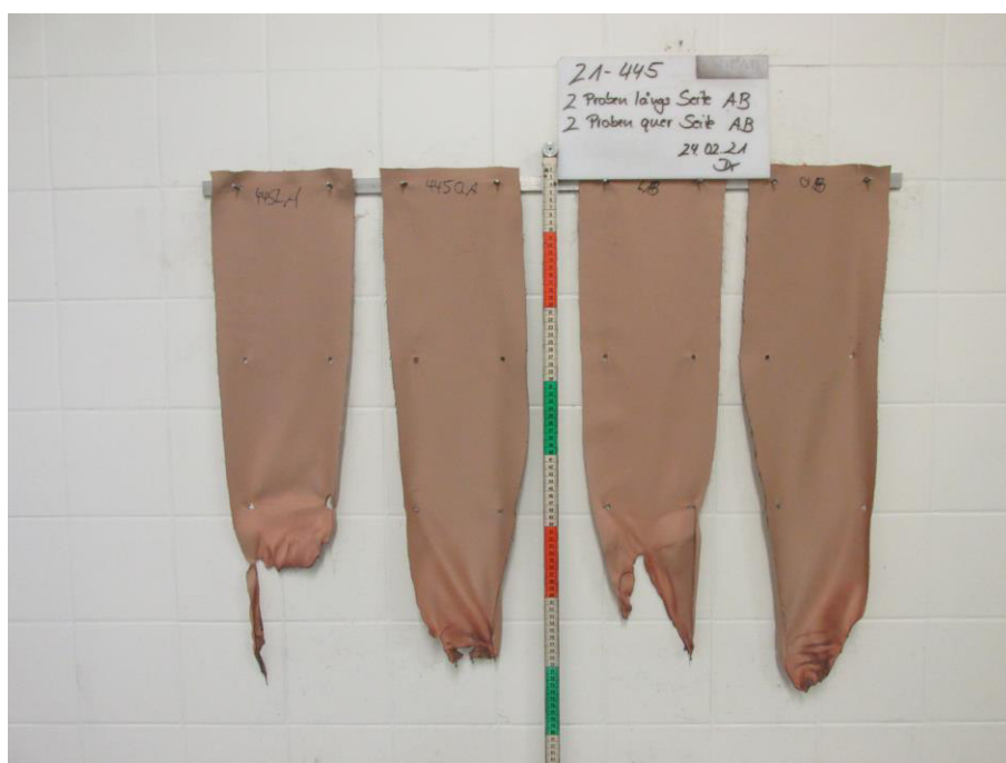
Bild 2: Aussehen der Proben nach dem Brandversuch
