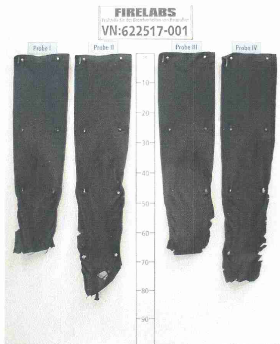
Bild 2 Aussehen des Probekörpers nach dem Brandversuch
