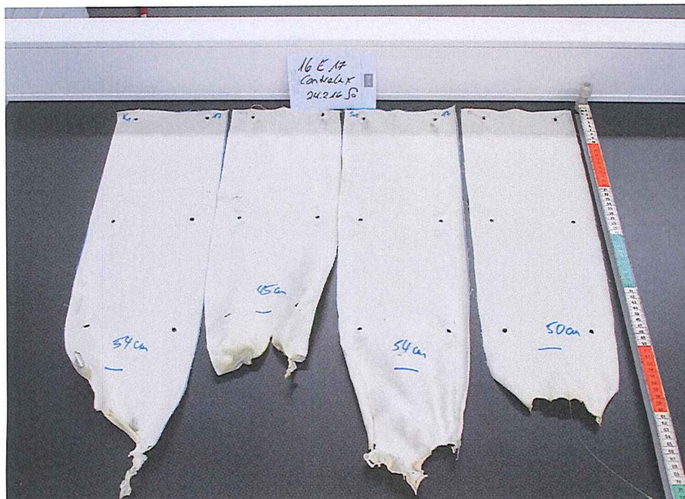
Bild 2: Aussehen der Proben nach dem Brandversuch
