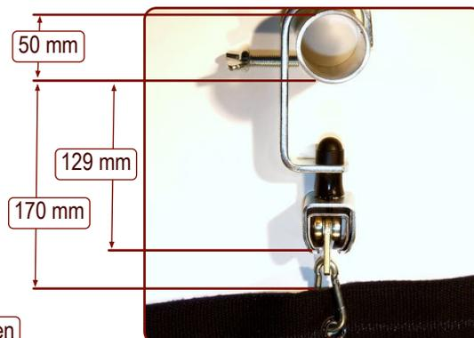
Vorhangrolle mit Stahlkugellager, Metallrolle mit 1-Loch, F=200 N (20kg/Rolle) (Bohrung 8 mm)
