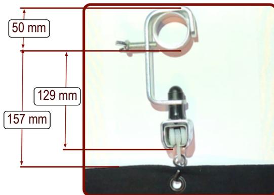
Kunststoff-Vorhangrolle mit zentralem Kugellager, F=100 N (10kg/Rolle) (Bohrung 4,9 mm)
