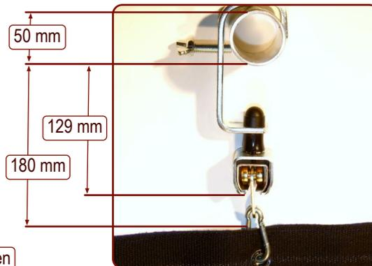
Vorhangrolle mit Stahlkugellager, Metallrolle mit 1-Loch, F=150 N (15kg/Rolle) (Bohrung 7 mm)
